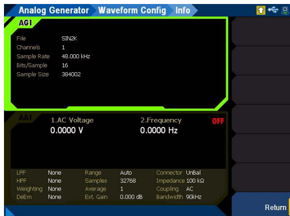
図 A-1 Analog Generator > Waveform Config > Info メニュー・ページ（任意波形）
