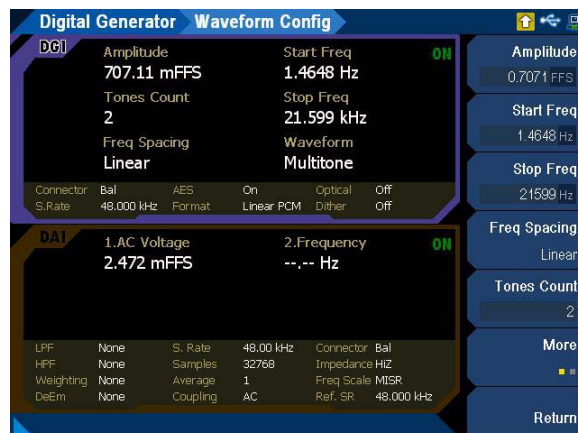
図 3-34 Digital Generator > Waveform Config メニュー・ページ 1 (マルチトーン波形)
