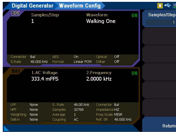
図 3-30 Digital Generator > Waveform Config メニュー・ページ（ウォーキング・ワン）
